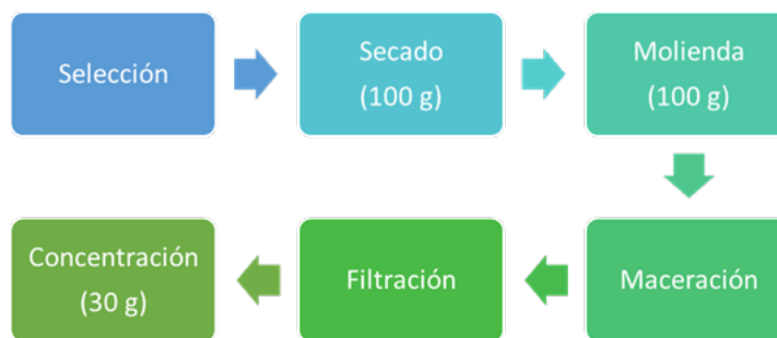
Figura 1. Flujograma de extracción de compuestos bioactivos del extracto metanólico de hojas de Luma chequen (Molina) A. Gray.
