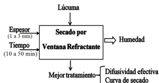
Figura 2. Esquema experimental de secado por ventana refractante.
