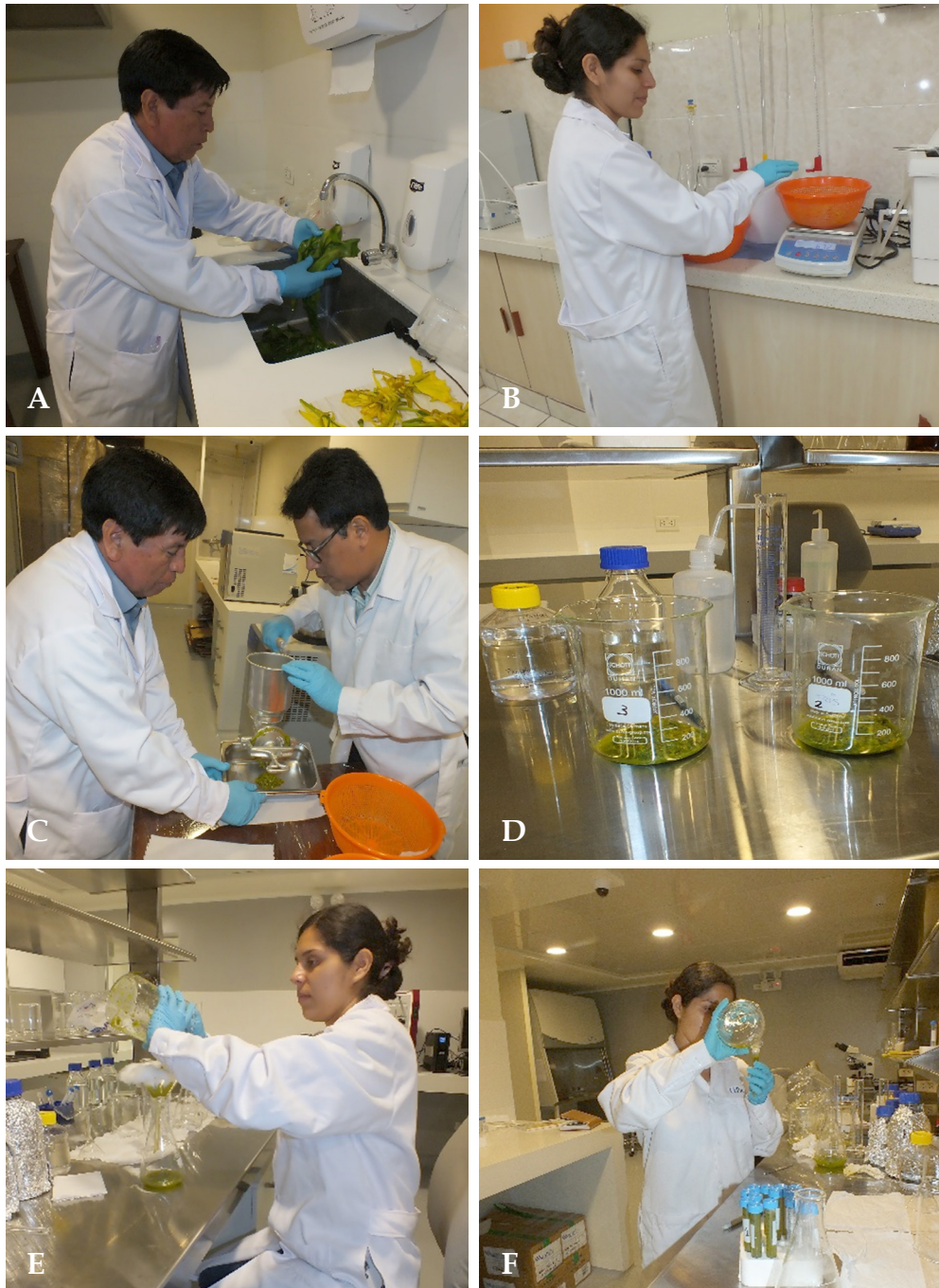
Fig. 3. Procesamiento de Ismene amancaes . A. Lavado y secado de las plantas; B. Pesado; C. Molido de las plantas; D. Separación y dilución en los buffers de extracción; E. Filtrado de la suspensión de la planta y el buffer de extracción; F. Llenado del sobrenadante para centrifugación; G. Matraz con el sobrenadante del buffer de extracción y planta.
