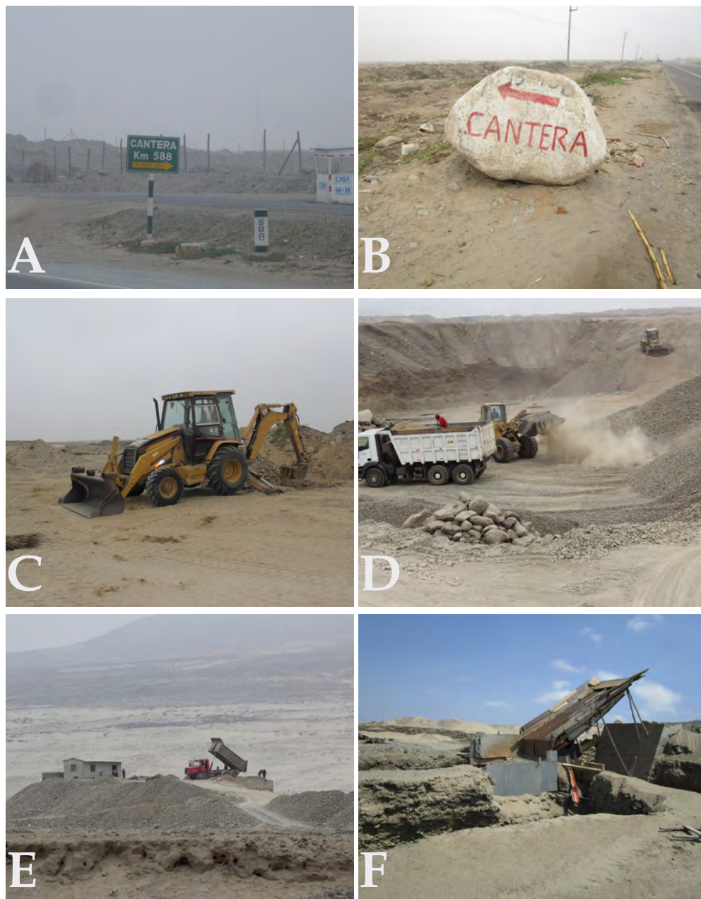
Fig. 1. A y B. Letreros que indican el ingreso a las canteras de extracción. C. Cargador frontal y retroexcavadora. D. Cargador frontal y volquete extrayendo gravilla y arena. E. Bolquete acumulando el material extraído. F. Tamizador de material.
