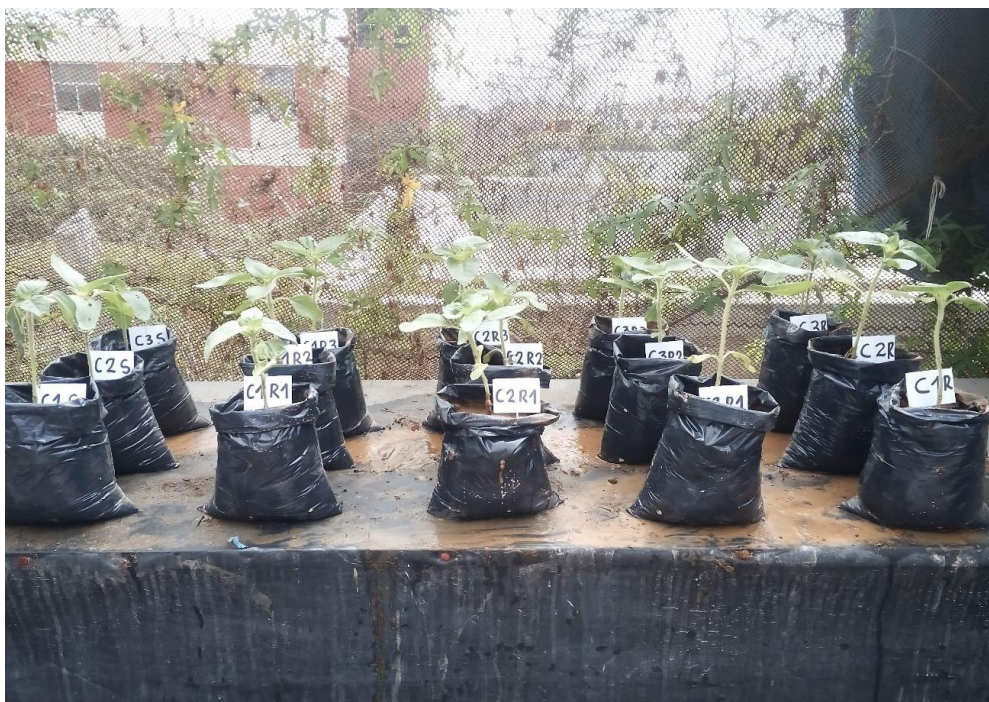
Fig. 1. Instalación del sistema experimental con las concentraciones: Suelo (Control), 25%, 50%, 75% y 100% (Relave puro).
