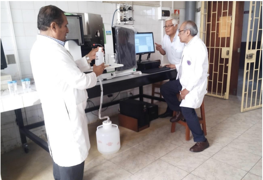
Fig. 4. En el momento de la determinación de los metales pesados Cu, As, Pb y Cd, mediante la espectrofotometría de absorción atómica.
