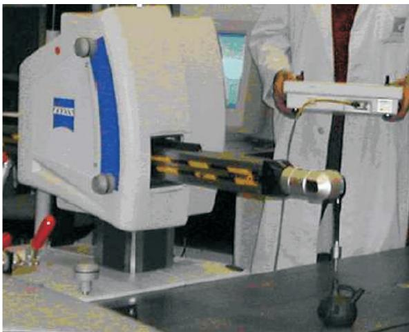
Figura 1. Escáner 3D
