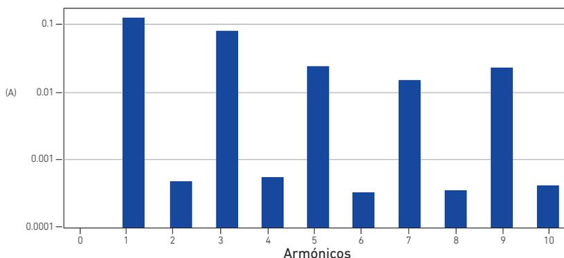
Los resultados de la contaminación armónica se observan en la Tabla 6. En este se presentan los armónicos, mientras que su visualización gráfica se presenta en la Figura 10. Para los elementos estudiados solo existe contaminación armónica de corriente.
