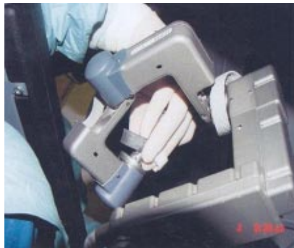
FIGURA 4: En Da Vinci, el cirujano se sienta frente a una consola de computadora. Él pone sus manos en estos "master," que traducen las mociones de las manos del cirujano en movimientos de los instrumentos quirúrgicos telerobóticos.
