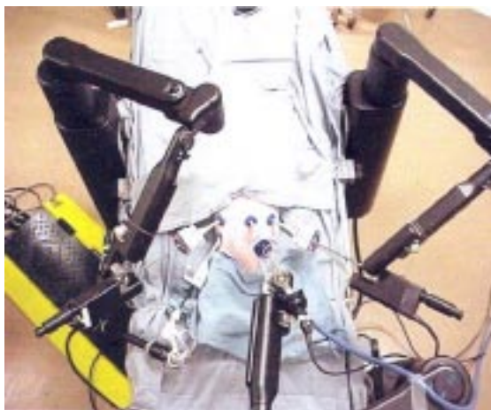
FIGURA 7: Los tres brazos de Zeus se sujetan directamente a la mesa operatoria. Un brazo sostiene la cámara de video y es controlado mediante comandos de voz. Los otros dos brazos sostienen los instrumentos quirúrgicos. (Fotografía cortesía de Celest Hollands, M.D., Louisiana State University Health Sciences Center, Shreveport, Louisiana.)
