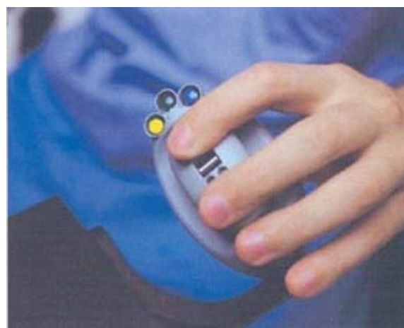
FIGURA 8: Los manubrios de Zeus traducen las mociones de las manos del cirujano en los movimientos de los instrumentos quirúrgicos. Los instrumentos se mueven en 6 grados de libertad. (Fotografía cortesía de Computer Motion Incorporated, Santa Barbara, California)
