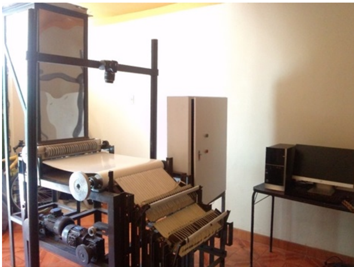
Figura 6. Máquina clasificadora de quinua por color ensamblada.
