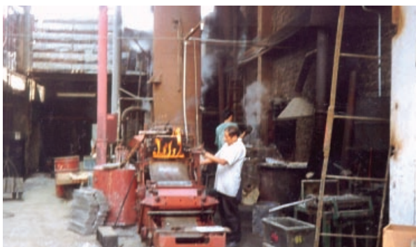
Figura 5. Fundición de plomo en fábrica de baterías.
