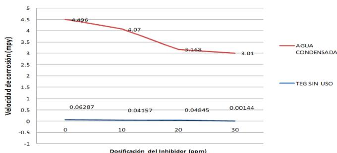
Los resultados de estos ensayos muestran que la velocidad de corrosión del agua de proceso sin inyección de inhibidor está en el orden de 4,5 mpy (0,114 mm/año) y se reduce hasta un valor de 3 mpy (0,076 mm) con inyección de 30 ppm en tanto que se registró valores despreciables de corrosión en el glicol en todos los casos (Fig. 3).
