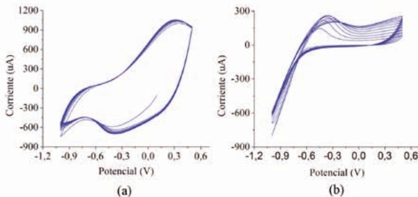
**Figura 1.** Respuestas voltamétricas frente a una solución de NaCl 0,1 mol L<sup>-1</sup> con sensores: a) PPy/PL y b) PPy/ACS.
