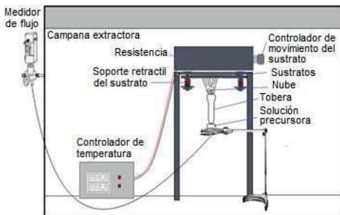
Figura 2. Esquema del equipo de rociado pirolítico.
