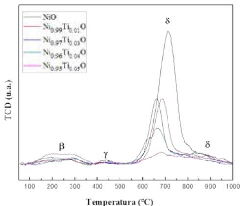
Figura 7. Perfil TPD-O<sub>2</sub> de los catalizadores Ni-Ti-O.
