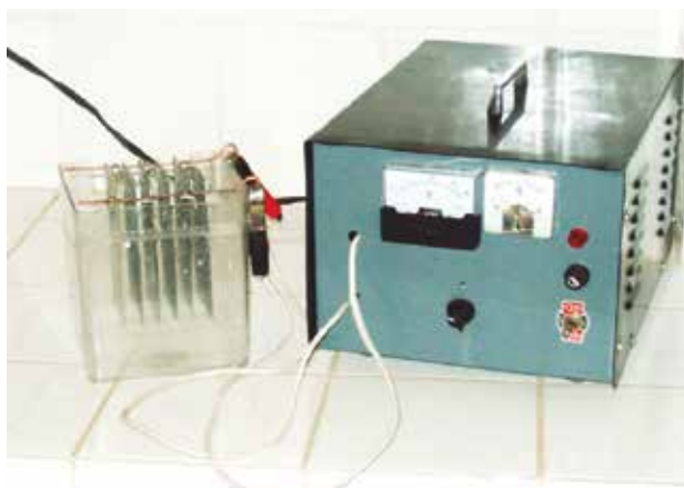
Figura 1. Reactor electroquímico y fuente de poder.
