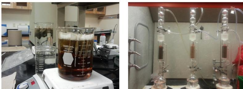
**Figura 2.** Extracción agua hervida (izquierda) y por el método Soxhlet (derecha)
