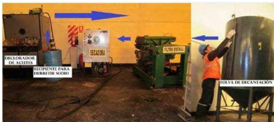
Figura 5. Proceso del tratamiento por dechlorinación y regeneración de PCBs, Inicia desde el equipo decolorinador, pasa a las tolvas de decantación, secadora, filtro de prensa y rellenado del aceite.
