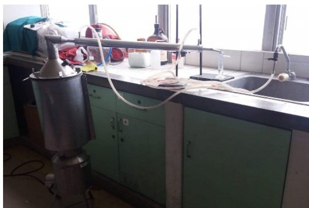
Figura 3. Equipo para extracción de aceites esenciales (Destilador por arrastre con vapor semi industrial)
