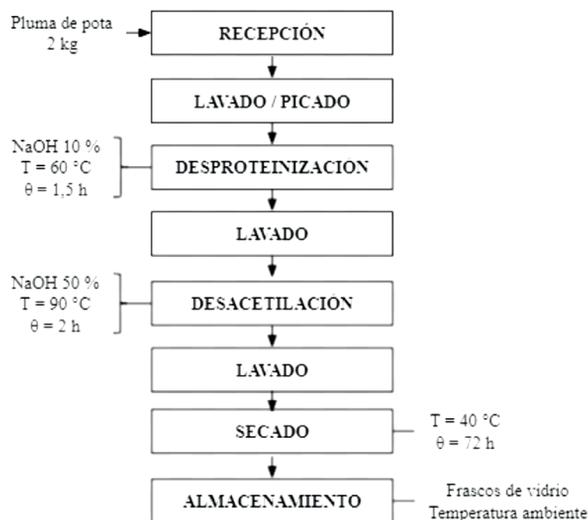
**Figura 1.** Proceso de extracción y obtención del quitosano a partir de la pluma de pota.
