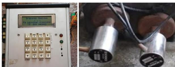
**Fig. 6.** Equipo utilizado: (izquierda) “StrainIndicator”; (derecha) Sensores de medición.
