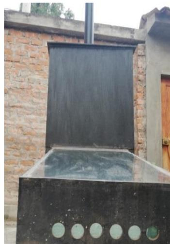
Fig. 13. Secador solar Indirecto-Pasivo.
