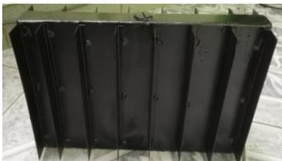
Fig. 14. Módulo con PCM de 30cmx20cmx3cm con aletas externas en los extremos del módulo con estructura de cobre pintado de negro mate.
