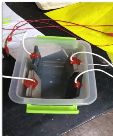
Fig. 1. Disposición de los ánodos de níquel y zinc
